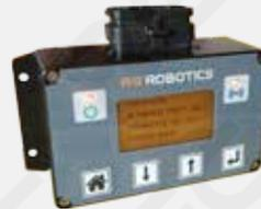
Обеспечивают возможность управления пропорциональными и дискретными гидравлическими агрегатами: распределителями, регуляторами расхода, различными электромагнитными клапанами. Также блоки управления имеют возможность собирать показания различных датчиков и обрабатывать их, выполняя различные алгоритмы: ограничения операций, циклы их выполнения.
