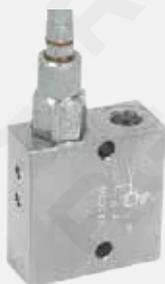
Клапаны последовательности VS2C в основном используются для обеспечения последовательной работы двух гидроцилиндров: при достижении давления настройки клапана первого цилиндра, клапан открывается и рабочая жидкость проходит в напорную магистраль второго цилиндра, предотвращая при этом возможность движения потока в противоположном направлении.
