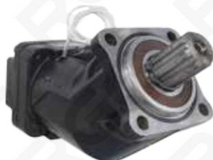
Область применения: автогидроподъемники, комбинированные дорожные машины, краноманипуляторные установки. Насосы RXP обладают исключительными характеристиками: низкий уровень шума, высокие скорости вращения, максимальное давление до 35 МПа, простота в использовании и большой срок службы.
