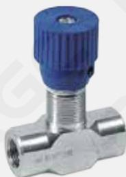
Дроссели VRFB 90° используются для регулирования расхода рабочей жидкости. Дроссели имеют высокую точность настройки и полную герметичность в закрытом состоянии. Регулирующий элемент игольчатого типа.
