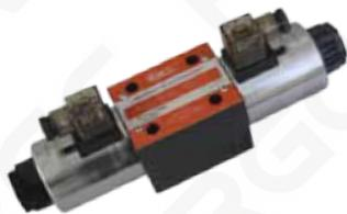
Предназначены для установки на монтажную плиту стандарта CETOP-3 и CETOP-05. В зависимости от числа положений золотника распределитель оснащается 1 или 2 электромагнитами.
