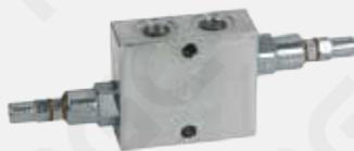
Предохранительные клапаны VAU позволяют ограничивать перепады давления между двумя гидравлическими линиями. Клапаны VAU применяют в качестве гидравлического тормоза гидромоторов, а также для ограничения рабочего давления в линиях гидропривода.
