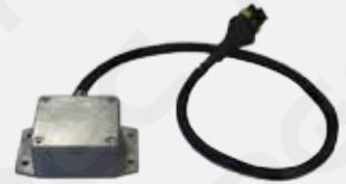
Предназначен для измерения угла поворота рабочего оборудования в 3-х осях. Также измеряет вращение вокруг своей оси в 3-х направлениях. Конструкция позволяет производить подключение датчиков последовательно с целью их объединения в общую сеть.
