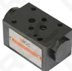
Предназначены для блокировки гидравлических двигателей, находящихся в нагруженном состоянии. Устанавливаются, в зависимости от модификации, совместно с модульной гидроаппаратурой на монтажную плиту типоразмера CETOP-3 или CETOP-5.
